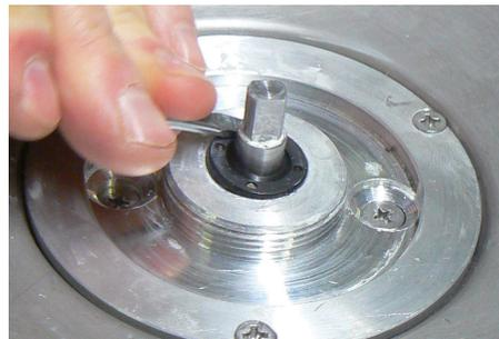
Coloque el nuevo sello de aceite con la parte plana de un destornillador para ajustarlo perfectamente
